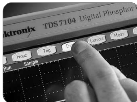
図61. タッチパネル・ディスプレイでは、キーボードのようにがたつきを気にすることなく、画面上のボタンに簡単にアクセスできます。
