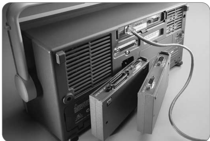
図55. TDS3000/Bシリーズは、多様な通信インタフェースに対応します。標準はセントロニクス・ポートですが、オプションでイーサネット/RS-232、GPIB/RS-232、VGA/RS-232に対応します。(TDS3000Bシリーズには、イーサネット・ポートが標準で付属します。)
