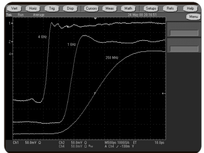
図47. 周波数帯域が高くなるほど、信号波形をより正確に表示できることを示したもので、250MHz、1GHz、4GHzの周波数帯域で取込んだ例です。
